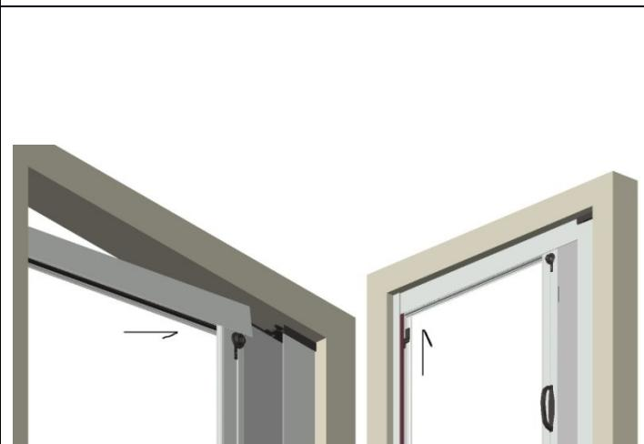
10) Τοποθετήστε τον πάνω οδηγό και στερεώστε τον ανεβάζοντας το τερματικό που βρίσκεται περασμένο μέσα στο αντίκρισμα
